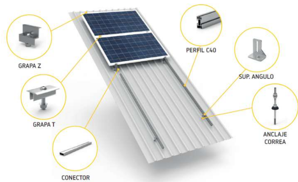
ESTRUCTURA COBERTA CENTRE CÍVIC: APLITECH CI-C1
